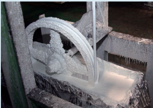
▲ あじろ鍍装された後、水性塗料により塗装される
