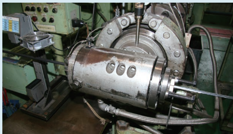
▲ 撚り合わせた導体にEPゴムを被覆して絶縁体に加工
